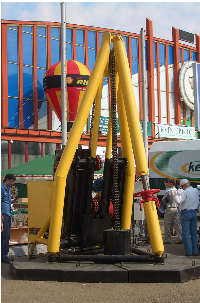
Выставочный образец привода скважинного штангового насоса ЭПМ-«Пирамида» Международная выставка «Нефть, газ, технологии», май 2007 г., г. Уфа
