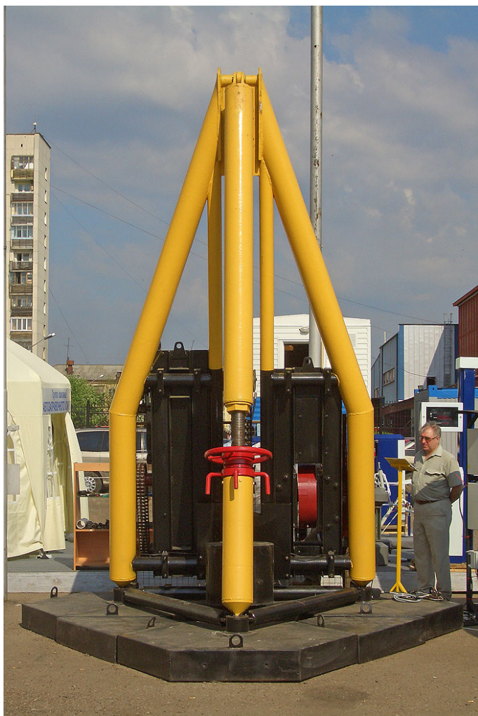
Выставочный образец привода скважинного штангового насоса ЭПМ-«Пирамида» Международная выставка «Нефть, газ, технологии», май 2007 г., г. Уфа
