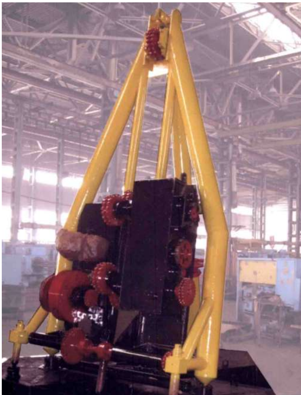
Рис. 5 – Общий вид наземного привода скважинного штангового насоса ЭПМ-12-3 «Пирамида»
